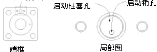
7. 更换端框内的启动销。您可能需要换位销工具 (002228-1) 以及一根6in. (153mm) 的缆线。
