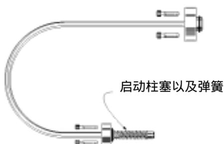
9. 将接合销（或者没有弹簧的启动柱塞）放入换向导引缆外壳的两端，测试缆线的运动。
